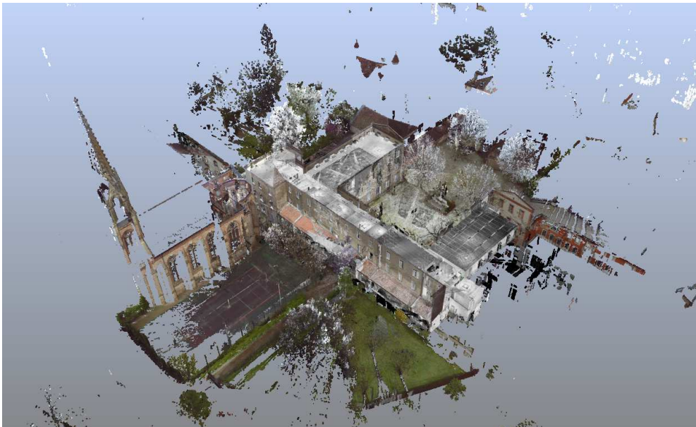
Figure 5: Nuage de points brut après calage des stations
