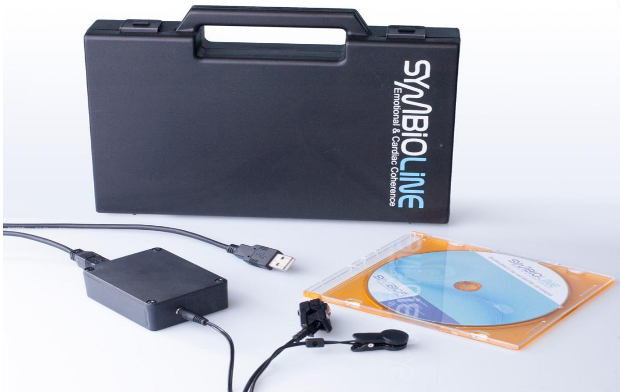
Figure n°11 : Logiciel Symbioline avec les deux capteurs (oreille et auriculaire) pléthismographiques, le boîtier permettant de transformer le signal et son CD.
