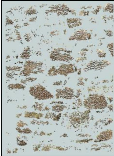
Figure 38 : Nuage de points des pierres résultant de la classification du nuage de points n°2 pour un seuil de -1286.905 [Cyclone]
