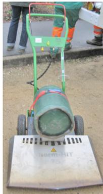
Figure 26 : Désherbage thermique à flamme indirect.
