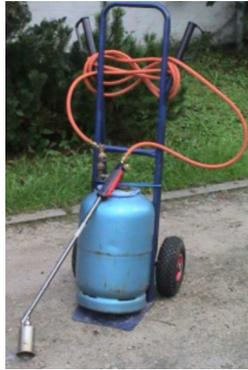
Figure 25 : Désherbage thermique à flamme direct
