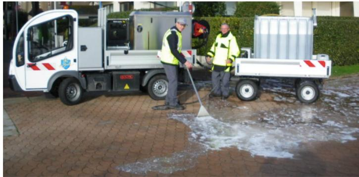
Figure 28 : Désherbage thermique à la mousse.
