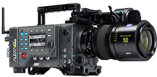
Fig 1.7 : ARRI, RED, Digital Bolex, Ikonoskop,.... De nombreux constructeurs ont sorti des versions monochromes de leurs caméras les plus prestigieuses. Le but : utiliser tout le potentiel des capteurs en supprimant tout les filtres et systèmes de mosaïque. Le résultat : plus de sensibilité, de piqué, et une plage dynamique étendue.
