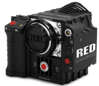
Fig 1.7 : ARRI, RED, Digital Bolex, Ikonoskop,.... De nombreux constructeurs ont sorti des versions monochromes de leurs caméras les plus prestigieuses. Le but : utiliser tout le potentiel des capteurs en supprimant tout les filtres et systèmes de mosaïque. Le résultat : plus de sensibilité, de piqué, et une plage dynamique étendue.
