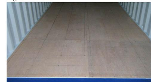
Fig.53: plancher de bois d'un conteneur.
