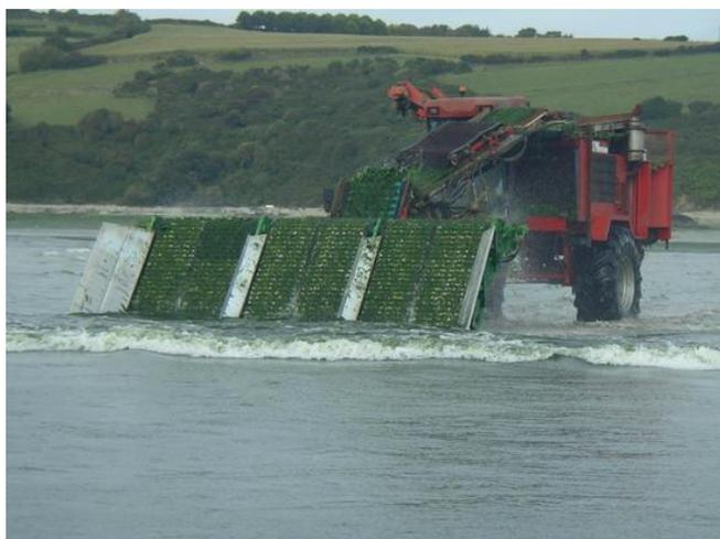
Figure 10 : Ramassage mécanique dans le filet d'eau de bas de plage (46).
