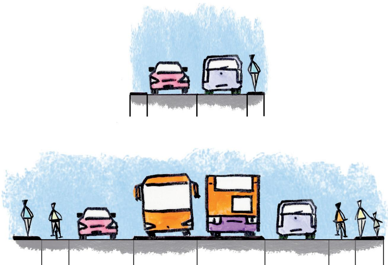
Figure 8 : Profil de chaussée sans site propre (en haut) et avec site propre (en bas) (Pierre DUHAMEL)
