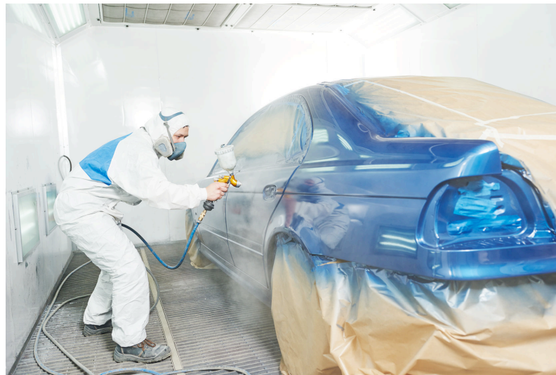
Figure 5 : Pulvérisation de peinture en cabine.
