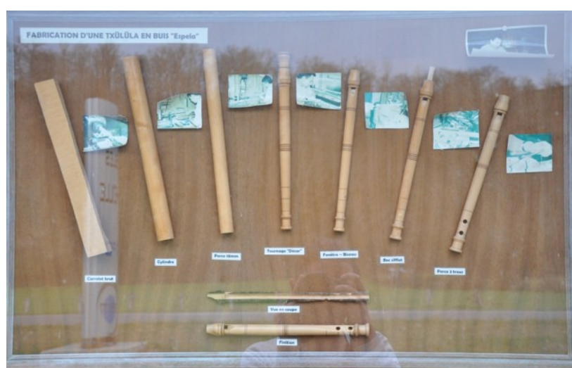
Figure 28 – Illustration des étapes de fabrication d'une flûte à trois trous dans la vitrine du frère ébéniste de Didier Queheille – Photographie de l'auteur (22 mars 2013)
