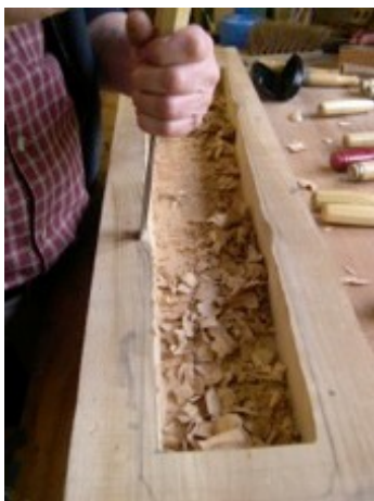
Figure 14 - Caisse de résonance du tambourin à cordes creusée, façon monoxyde - © Jacques Roth
