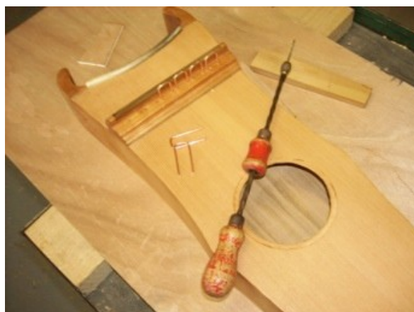
Figure 19 - Mise en place des cavaliers en cuivre © Jacques Roth
