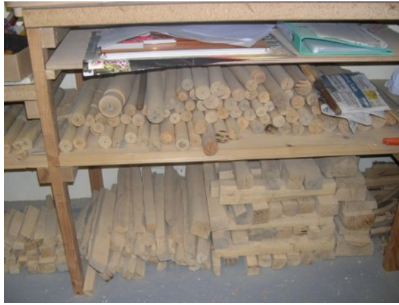
Figure 22 - Carrelets en bas - dégrossis en cylindres en haut - © Jacques Roth
