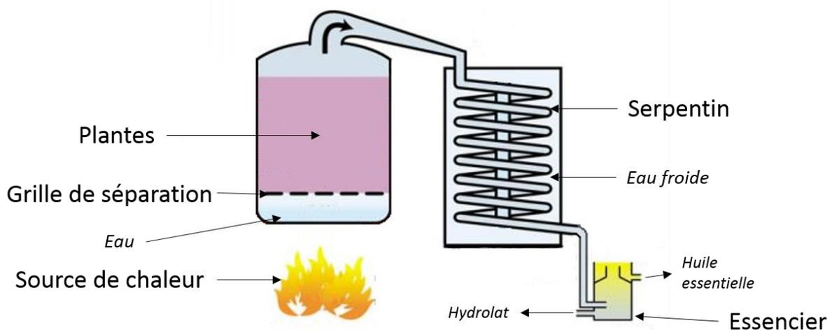
Figure 8 : Schéma d'une installation de vapo-hydrodistillation
