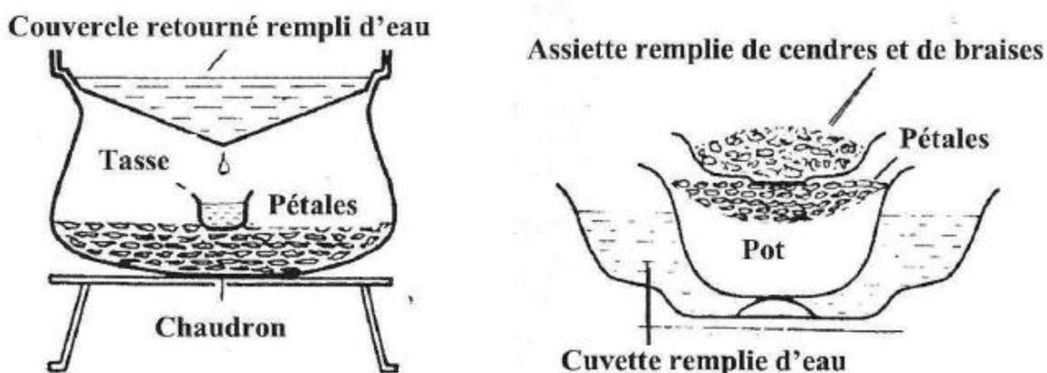
Figure 9: Schéma d'une installation de distillation sèche (d'après [27])
