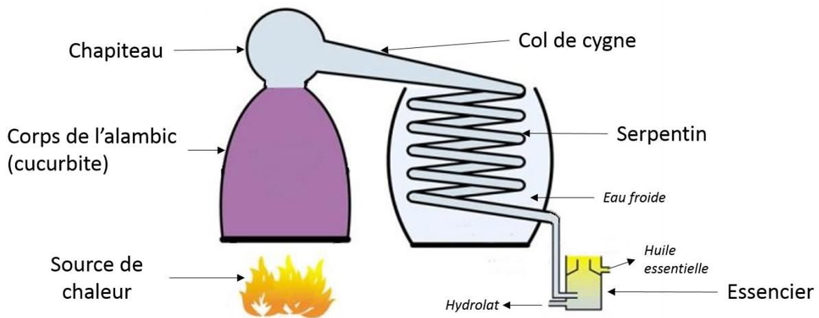
**Figure 6 : Schéma d'un alambic**
