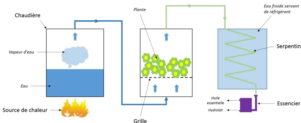
**Figure 7: Schéma d'une installation d'entraînement à la vapeur**
