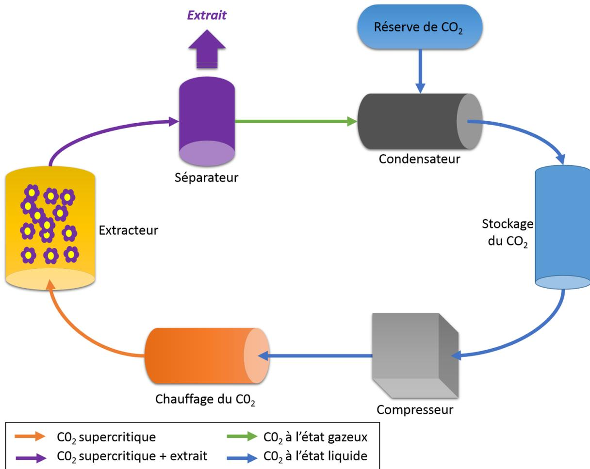
**Figure 10 : Schéma simplifié d'un extracteur au CO<sub>2</sub> supercritique**
