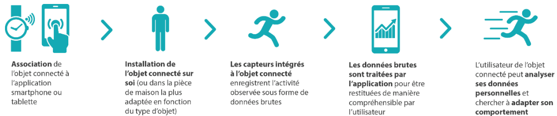
Figure 2 : principe de fonctionnement d'un objet connecté (8)
