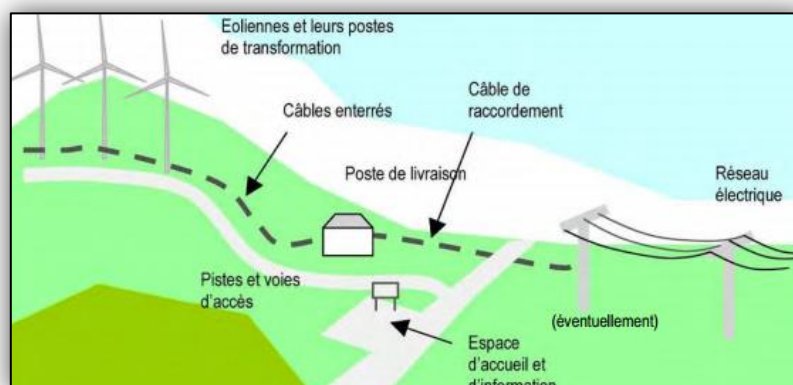
Figure 2 – Schéma descriptif d'un parc éolien terrestre Source : Guide de l'éolien, 2010
