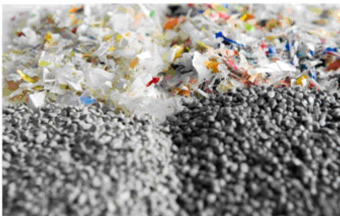
**Figure 9 : Copeaux et granules de PP recyclé (source : DSD).**
