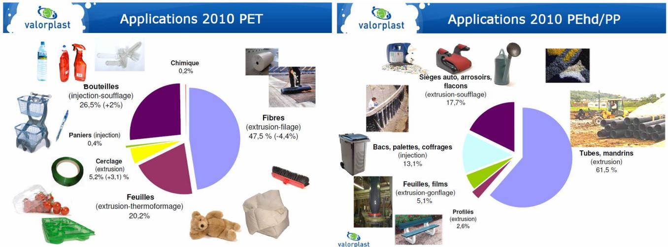
**Figure 6 : Applications du PET recyclé et du mélange PEhd/PP recyclé<sup>24</sup> (Valorplast 2011)**
