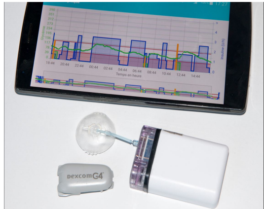
Figure 46 - Composants du pancréas connecté Diabeloop
