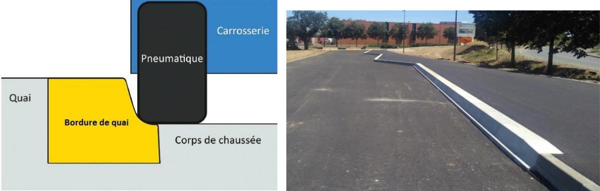
Figure 43 : Bordure de quai utilisée au terminus des Sept Deniers (travaux 2013)
