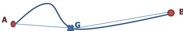
Figure 32 : Points particuliers pour le calcul de sinuosité
