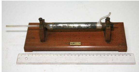
Composé de tubes de verre revêtus d'une feuille d'étain connectés à 2 bornes de liaison, il forme l'ozone par la décharge d'un courant électrique lorsque l'oxygène y passe.
