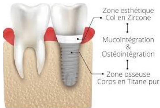
Figure 44 : illustration de l'implant Z1 MD .
