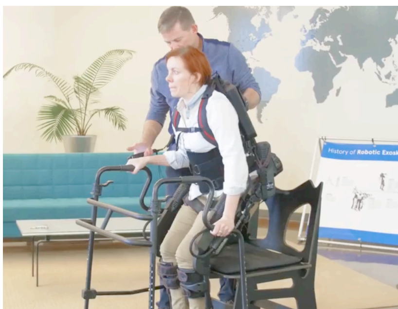
Figure 9: Ekso Bionics : une combinaison bionique ou exosquelette : un robot portable qui aide les gens à remarcher. Disponible sur: https://eksobionics.com/?lang=fr 44
