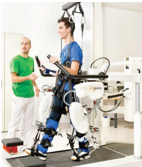
Figure 7: marche avec allègement du poids du corps et exosquelette. Robot Lokomat – Medimex. Disponible sur : https://www.medimex.fr/lokomat.html 42
