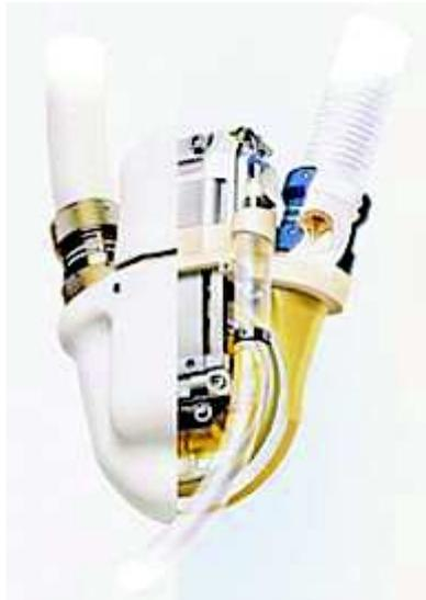
Figure 5 : Pompe monoventriculaire gauche pulsatile Novacor<sup>®</sup>
