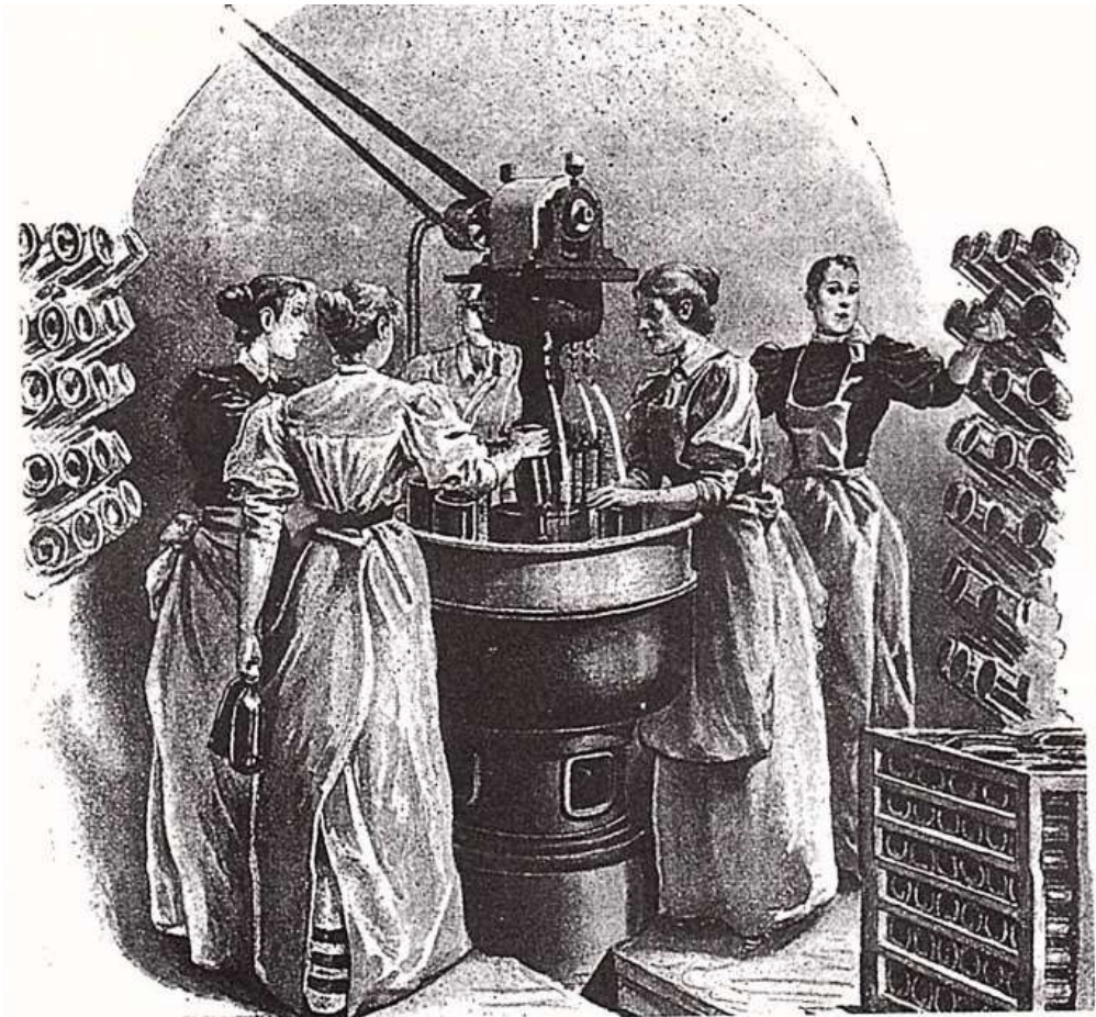
Figure 137 : Machine à rincer les bouteilles, 1896 (3)
