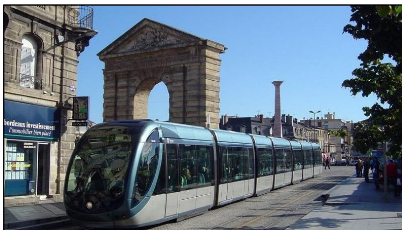
ILLUSTRATION 5 : Tramway de Bordeaux, le premier sans caténaire (6)
