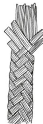
Illustration 4: Schéma d'une corde tressée avec une âme de fils. © Chaire ICiMa
