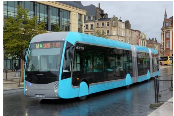
Le Mettis de Metz. Capacité 150 personnes . 24 m de long. Circule en site propre à 90 %
