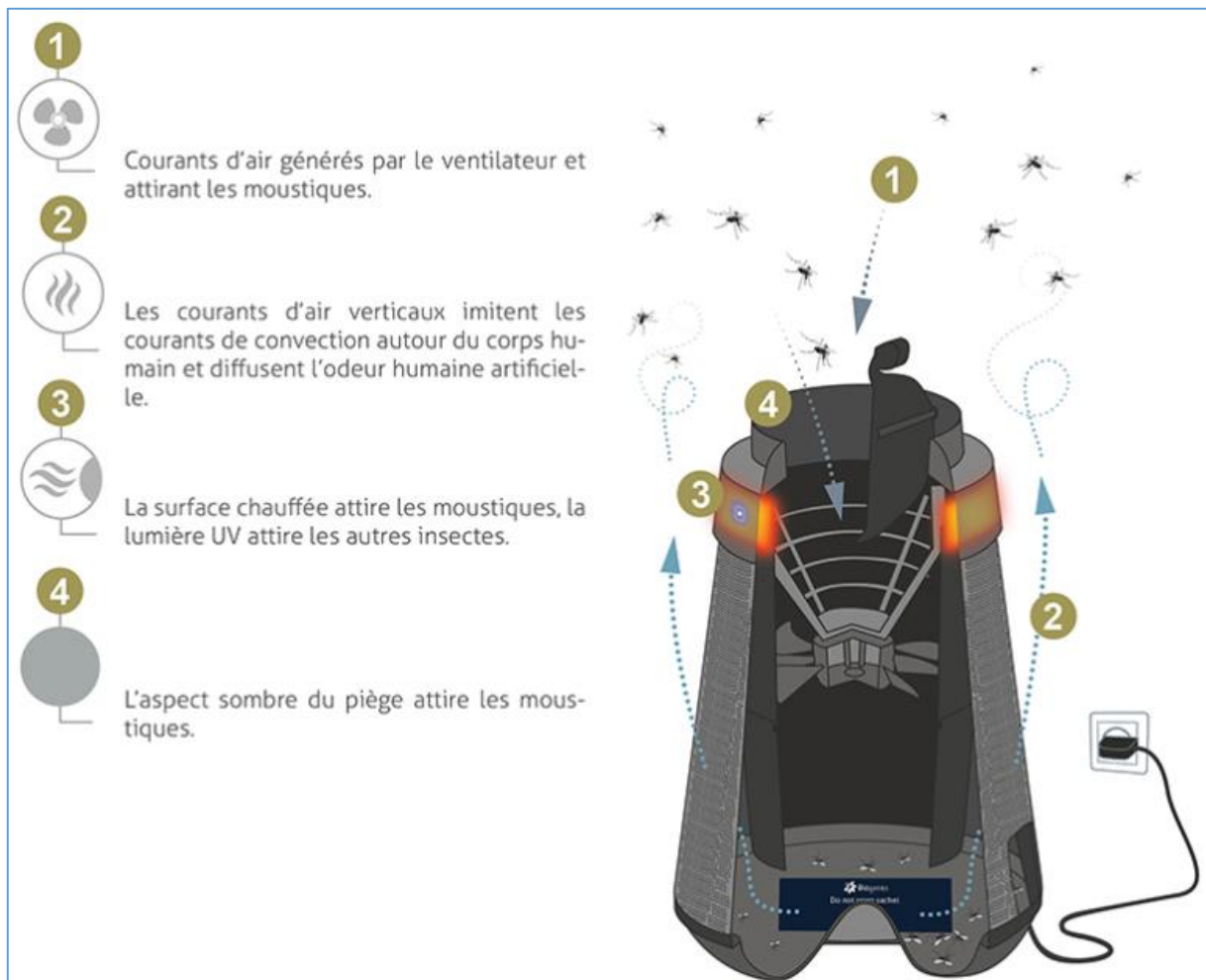
Figure 40 : Exemple de pièges Biogents : explication du fonctionnement du BG-Home.(108)
