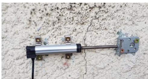
Figure 9: Fissuromètre (Source : Cementys)
