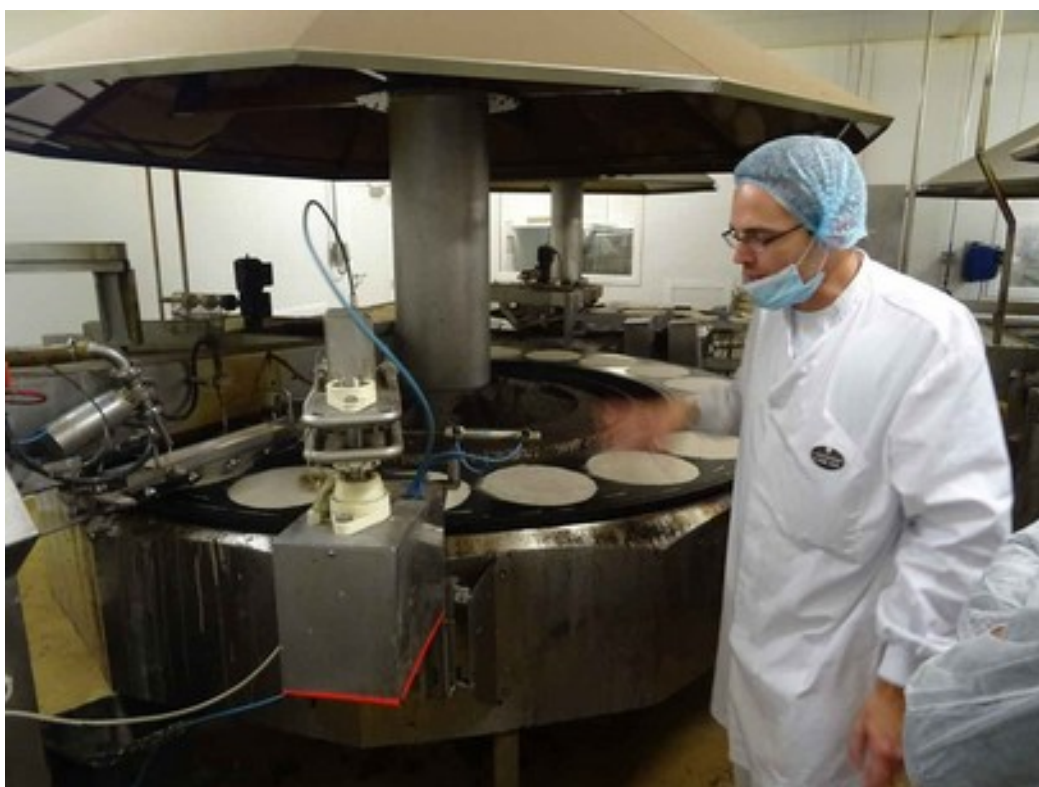
Figure 12 : Photographie d'une chaîne de production de galettes de sarrasin en Bretagne. Les salles d'emballage sont climatisées en permanence. Le port de la blouse, de la charlotte et du masque est obligatoire.
