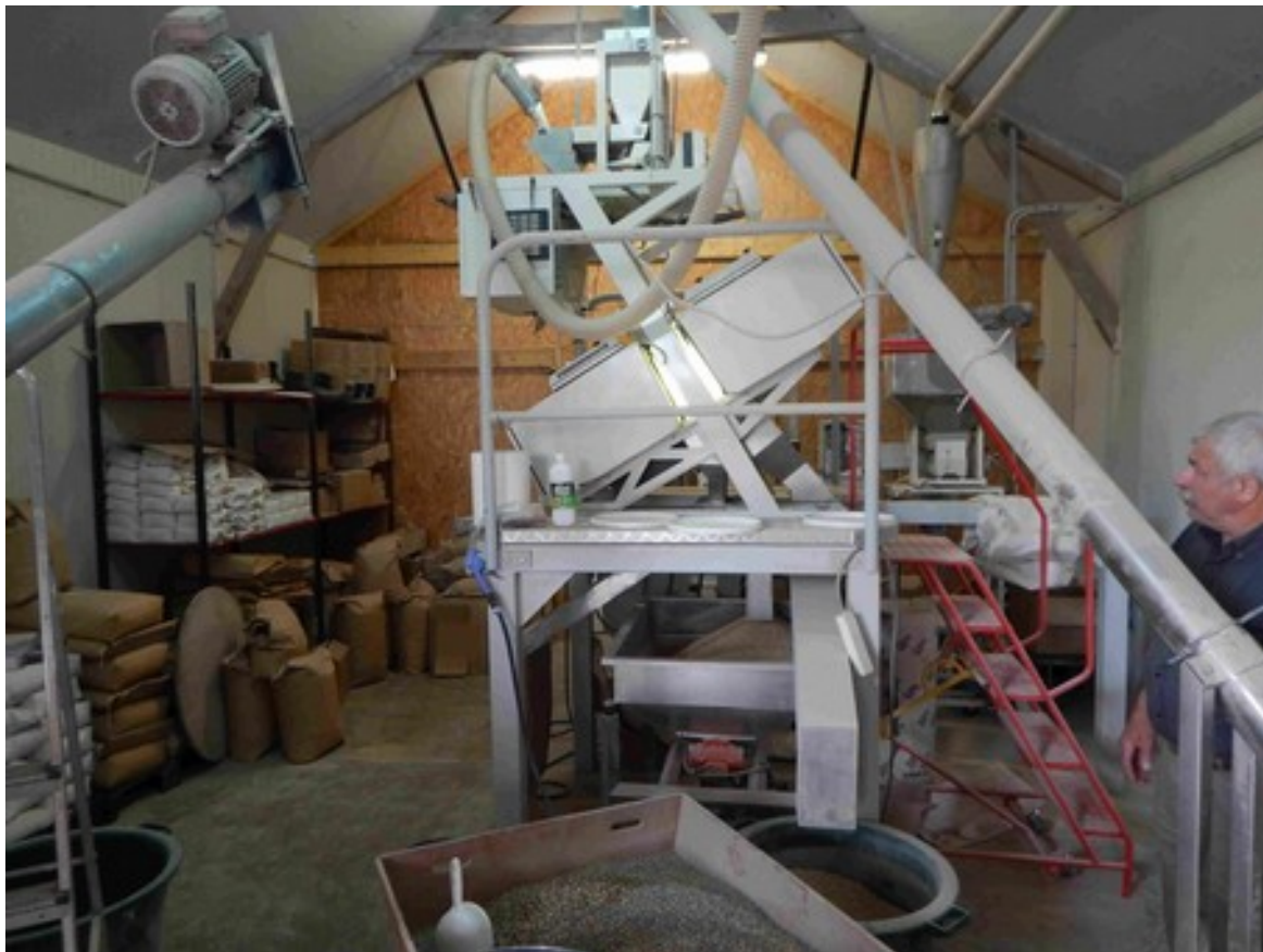
Figure 14: Un trieur optique (coût d'environ 80 000€) chez un agriculteur d'Ile et Vilaine spécialisé dans la transformation et la vente de céréales en circuits courts. Cet appareil permet notamment de tirer les graines décortiquées des non décortiquées, ainsi que les graines à forme et densité similaires. (Source : auteur)
