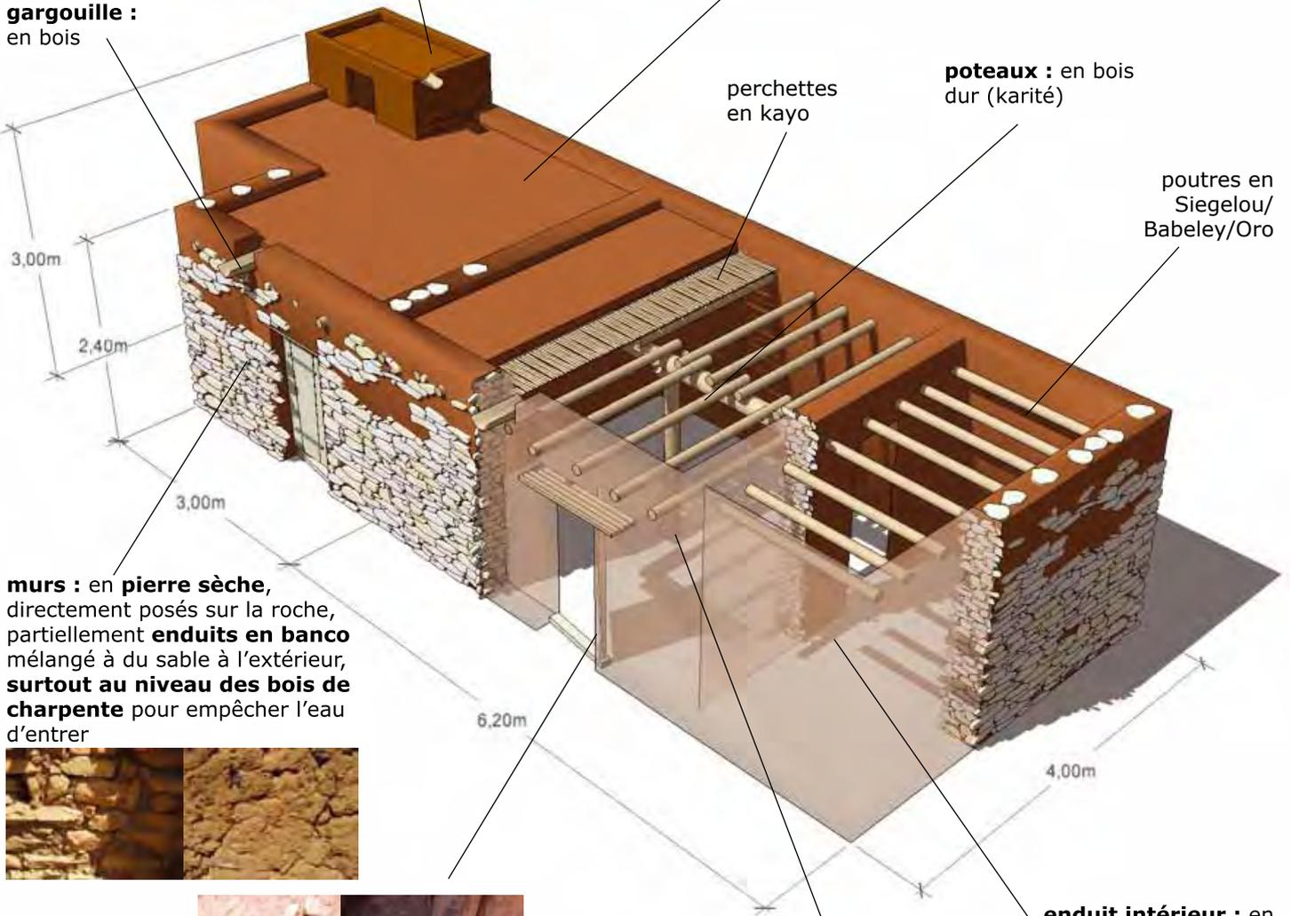
**murs :** en **Pierre sèche**, directement posés sur la roche, partiellement **enduits en banco** mélangé à du sable à l'extérieur, **surtout au niveau des bois de charpente** pour empêcher l'eau d'entrer
