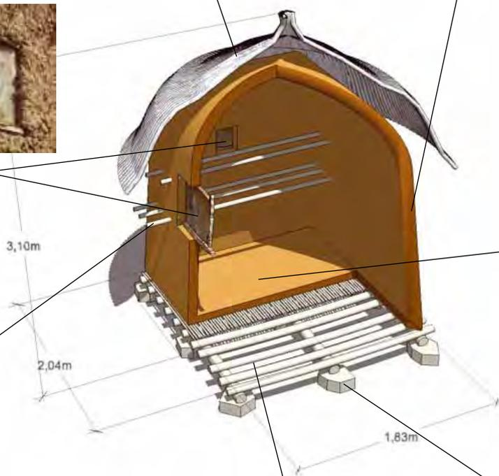
**morceaux de bois encastrés** dans les parois pour créer des **étagères** dans le grenier et suspendre des choses à l'extérieur. Sans doute rôle structurel pour renforcer
