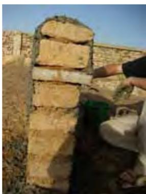
tests de stabilisation de la terre pour faire des briques : 3, 4, 5 et 6 % de ciment et muret échantillon pour essayer un haut de mur
