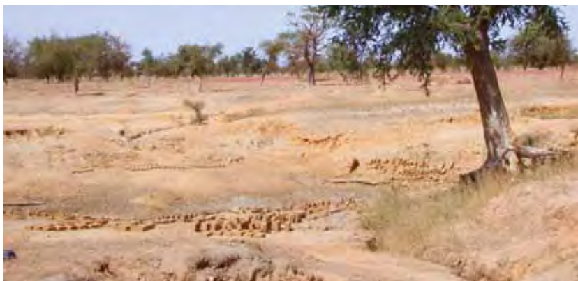
carrière de banco et lieu de moulage et de séchage des briques
