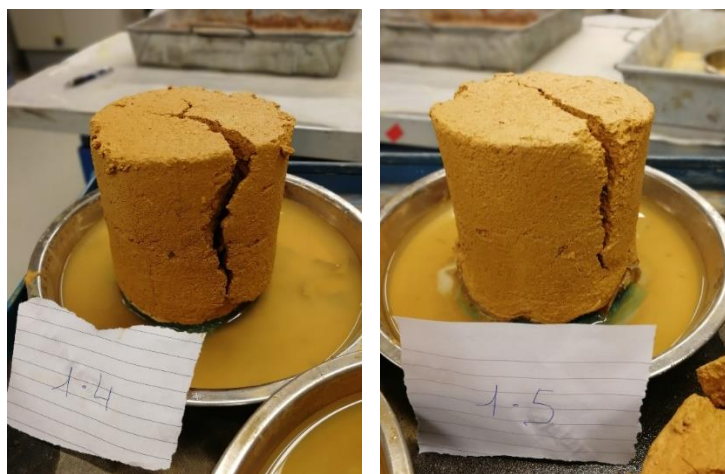
Figure 87 : Effondrements d'échantillons par ouverture de fissurations verticales
