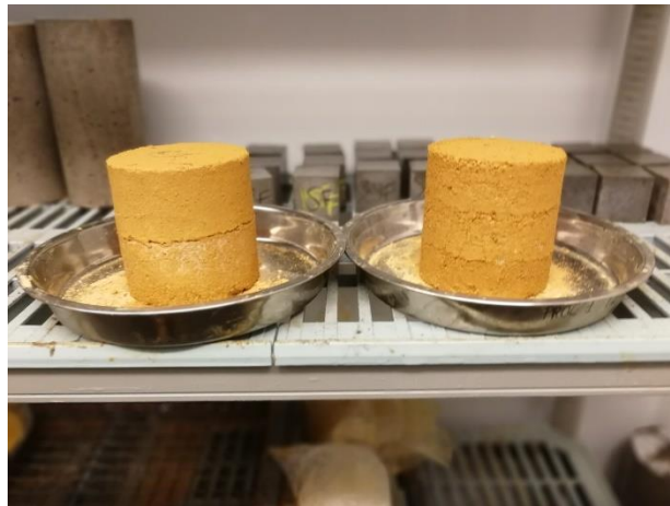
Figure 89 : Présence de fissurations horizontales au niveau des interfaces des couches
