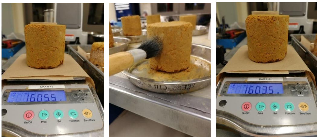
Figure 47 : Mesure de la perte de masse écaillée après brossage
