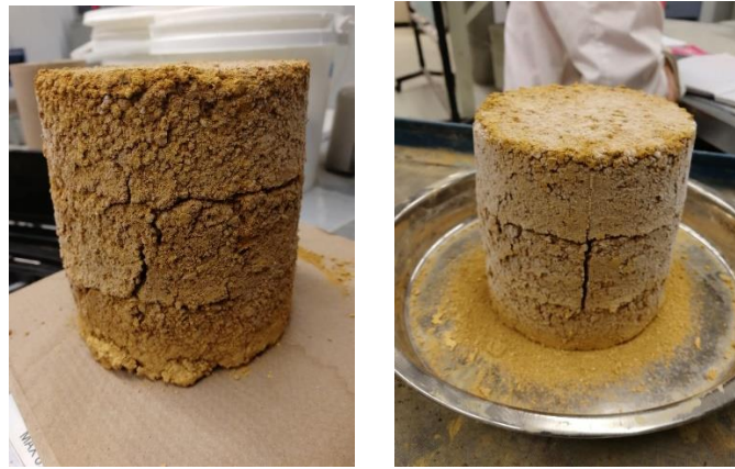
Figure 90 : Développement des fissurations après le gel : début d'écaillage
