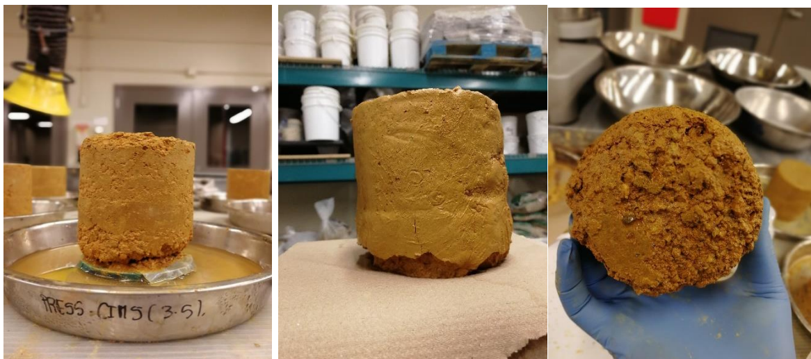
Figure 92 : Erosion de la partie basse des échantillons soumis à l'absorption d'eau par capillarité
