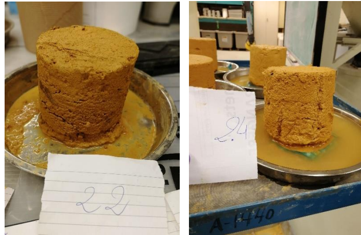
Figure 88 : Effondrements d'échantillons par perte de stabilité (saturation)
