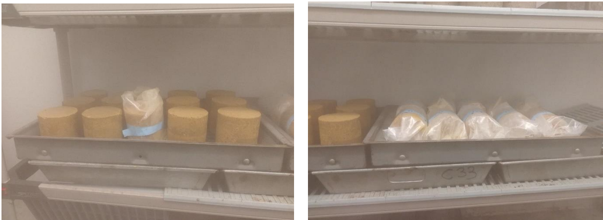
Figure 44 : Cure des échantillons stabilisés (à gauche) et conservation des échantillons non-stabilisés (à droite)
