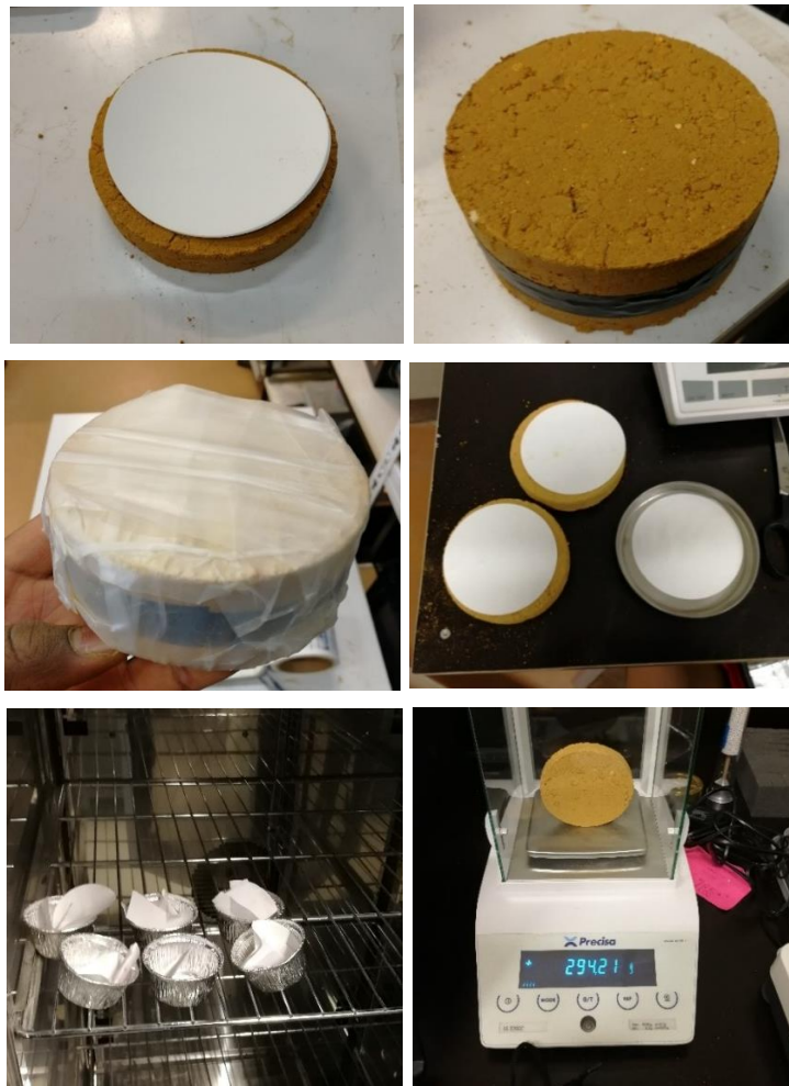
Figure 33: Illustrations du protocole expérimental de mesure de la succion de la terre
