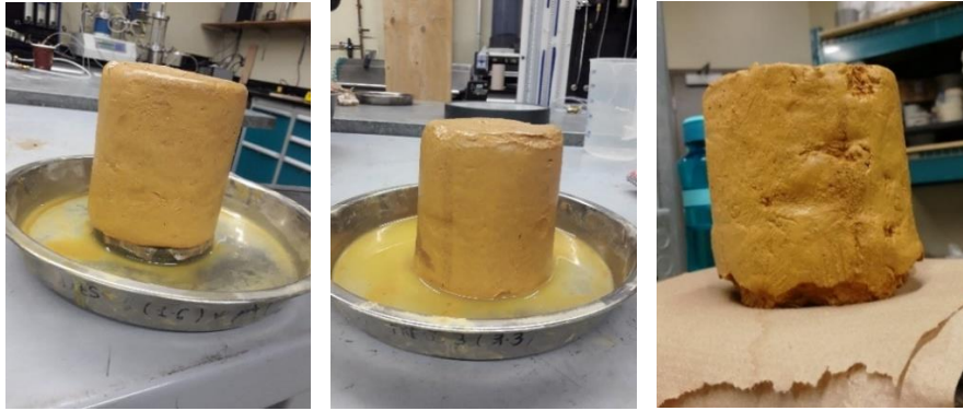
Figure 70 : Forte humidification et sensibilité des échantillons non-stabilisés sans gel
