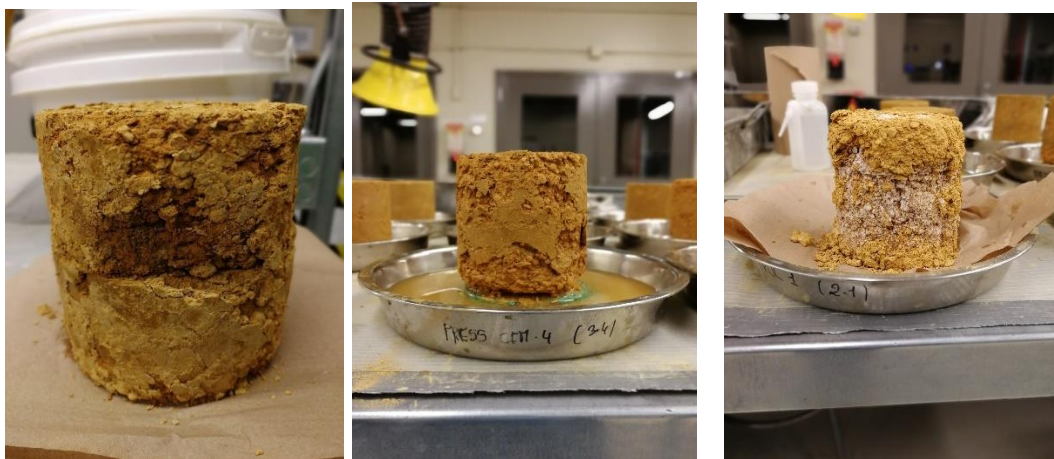
Figure 91 : Ecaillage des échantillons entraînant des pertes de masse
