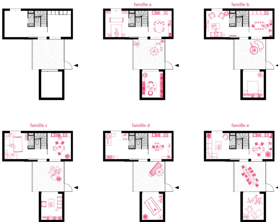
Fig. 26 : plans de différentes appropriations possibles de la pièce en plus dans un même logement
