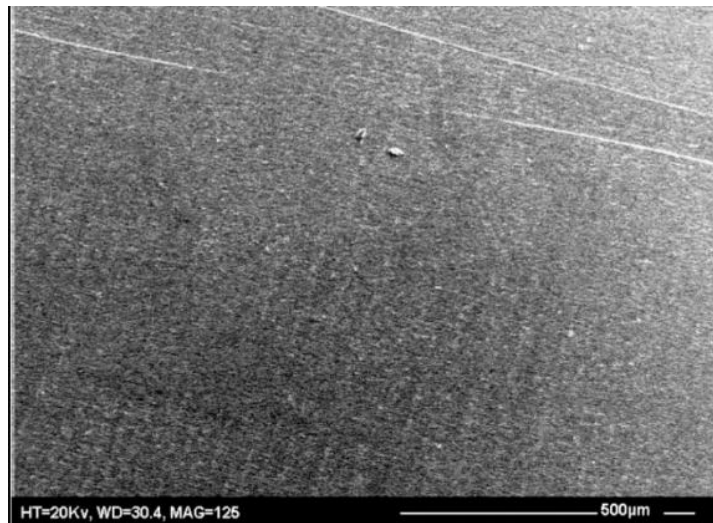
Figure 12 : Image de surface de composite après une finition à l'aide d'une fraise tungstène, vue au microscope électronique à balayage avec un grossissement de 100 (32).
