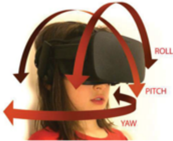
Figure 3 : Système utilisant uniquement l'orientation.
