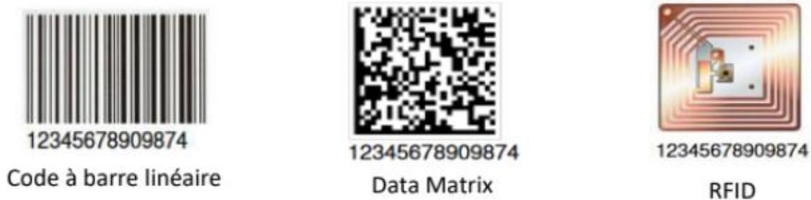
**Figure 2** : Exemple de supports IUD
