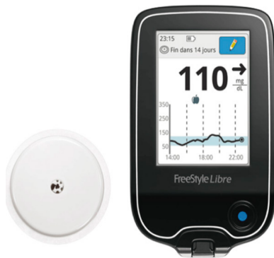
Figure 9 : Capteur de glycémie FreeStyle Libre (à gauche) et son lecteur de glycémie (à droite). [43]
