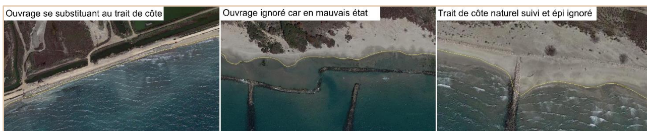
Figure 13 : Exemples de prise en compte des ouvrages dans la digitalisation du trait de côte, TRIAY Lucas, 2022
