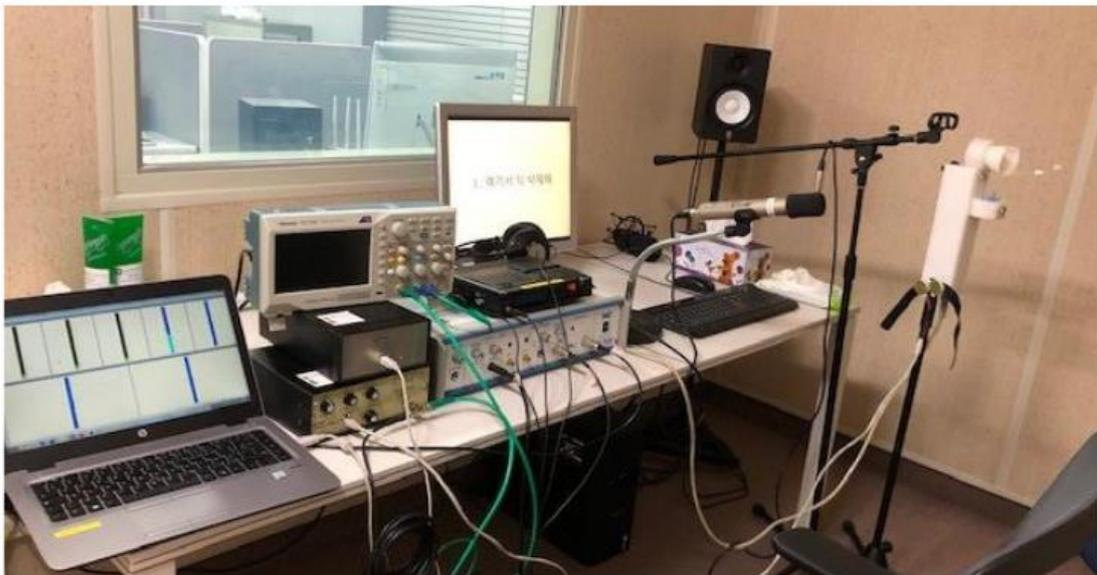
Figure 12. L'ensemble des dispositifs (EVA, EGG, oscilloscope) utilisés lors de la prise de données<sup>7</sup>.
