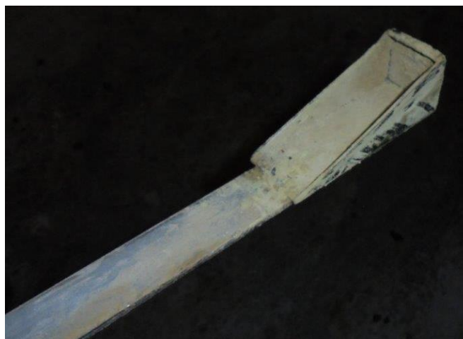
Figure 30 : Nouvel outil de prélèvement réalisé par l'équipe maintenance.
