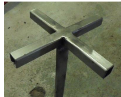
Figure 31 : Croix de sécurité mis à l'extrémité de l'outil de prélèvement.
