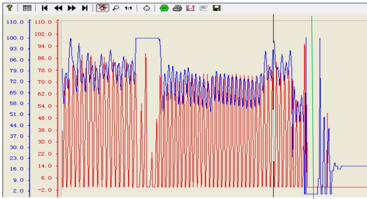
Figure 7 : Exemple de consommation de chaud / froid d'une CTA selon 2 consignes, conférence de JP Bovée en janvier 2024 (22)
